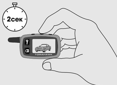
Дополнительный канал используется для дистанционного управления дополнительными устройствами, модулями стеклоподъемников, организации подсветки пути к а/м ближним светом фар в темное время суток и т.п.
