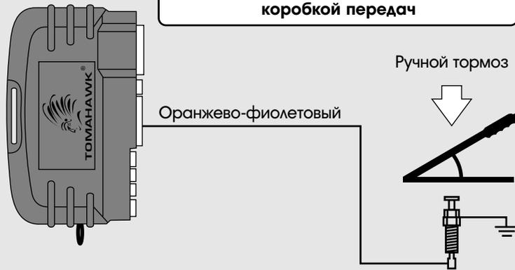
**При установке на а/м с автоматической коробкой передач**
